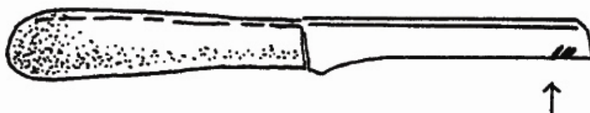
Рис. 31: Техника скобления для удаления неровных выпуклостей на трости.
