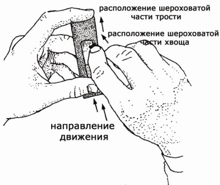
Рис. 11. Шлифовка трости хвощом. Заметьте, что угол, под которым располагается шероховатая часть хвоща, не совпадает с направлением расположения самой трости.
