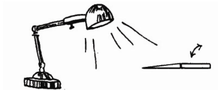
Рис. 30. Поиск неровных выпуклостей на трости. Держите трость в относительно параллельном поверхности стола положении, сделайте так, чтобы на нее падал максимум света, и поворачивайте при осмотре трость из стороны в сторону.
